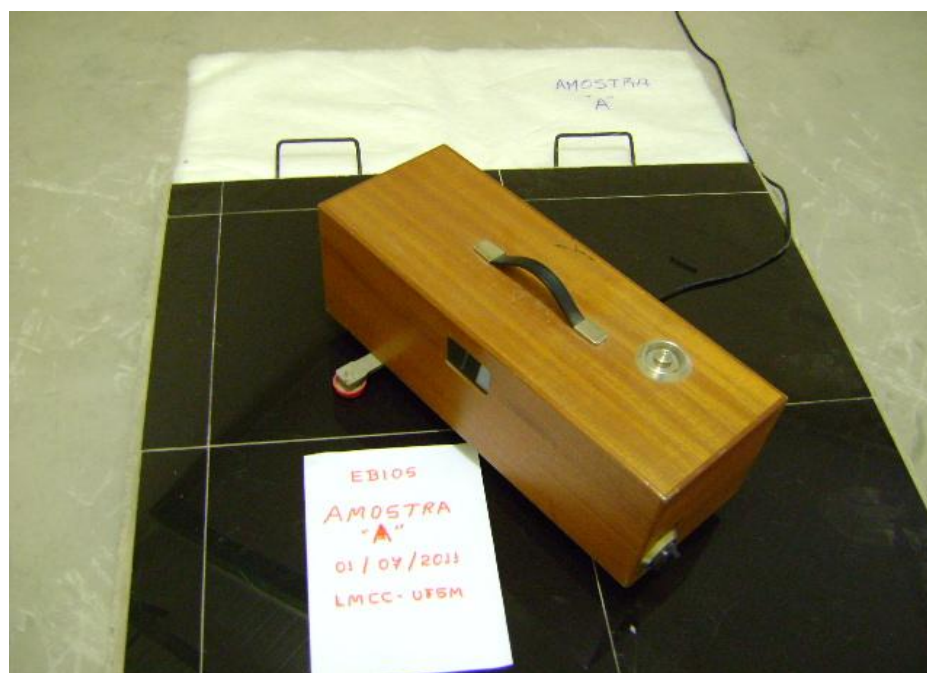
ENSAIO 1 – Laje + Manta PISO EBIOS 10 mm AM A + Referência (contrapiso + porcelanato)
